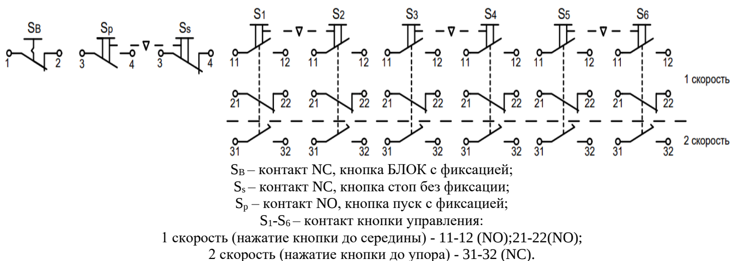
Рис.8 Схема контактов постов серии ПКТ с кнопками блокировки, пуск и стоп
